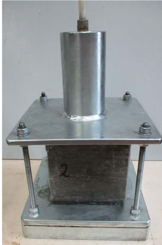
Figura 3. Apparato sperimentale per la misura della permeabilità all'acqua sotto pressione.
