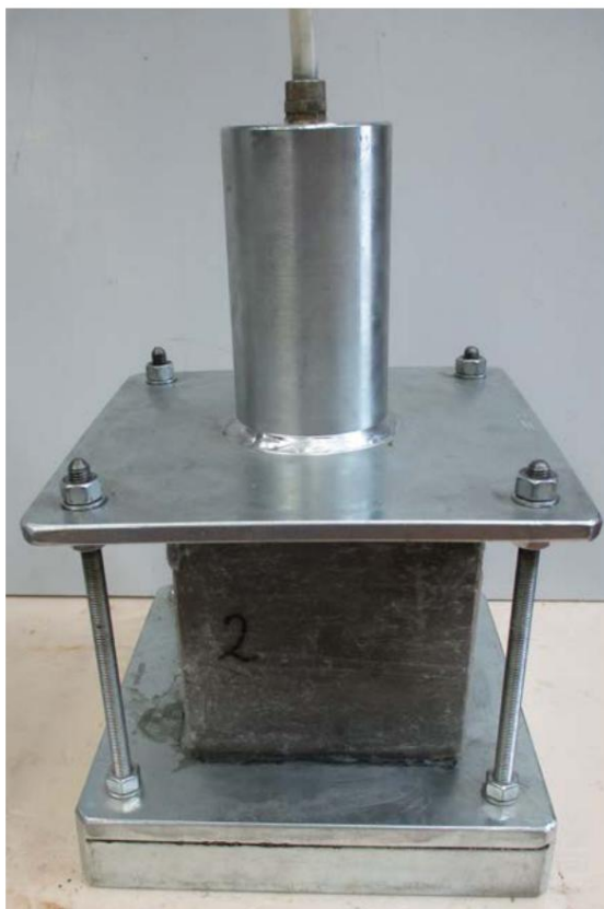
Figure 3. Montage expérimental pour mesurer la perméabilité à l'eau sous pression.
